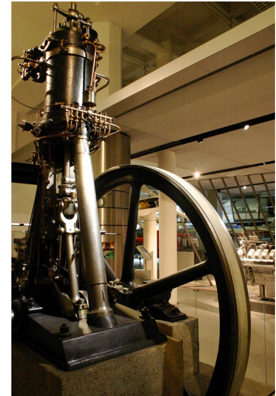
Le moteur diesel original de 1893 (Deutsches Museum, Munich) \eta_{1897} = 26 \%
